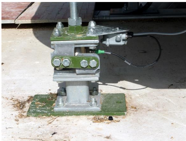
Fig. 6 Piedino di pesatura con cella di carico incassata; amplificatore montato sul piedino di pesatura
