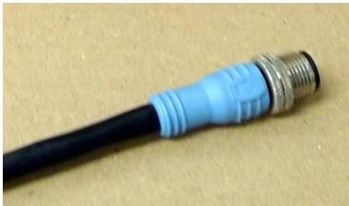
Fig. 21 Blu – segnali bus come CAN-Bus e RS485
